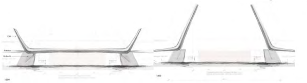
Figur 3. Skiss som visar den öppningsbara brodelen i slutet respektive öppet läge. Källa Dissing+Weitling, Sweco.
