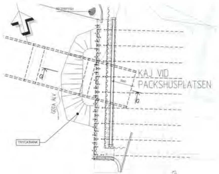
Figur 10. Eventuell tryckbank vid grundläggning på spont i kajkonstruktion. Källa: Sweco.
